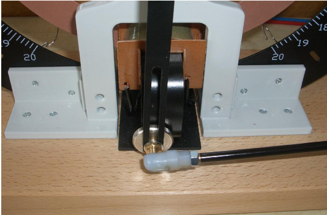
Abbildung 2: Das Gestänge, welches die Kraft vom Motor auf die Feder überträgt. Nach Lockern der Schraube hinter der senkrechten Stange kann die untere Stange verschoben werden. Dadurch ändert sich der Winkel, um die der Exzenter die Feder verdreht. Zu sehen sind hier auch die Spulen.
