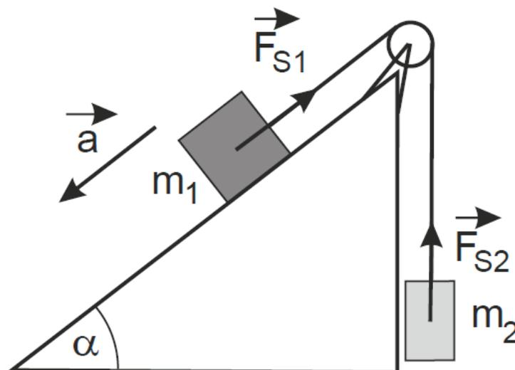
Der Block '1' (Masse  $m_1$ ) gleitet eine um den Winkel  $\alpha$  geneigte Ebene hinab, so dass er über ein Seil und eine Umlenkrolle den frei hängenden Block '2' (Masse  $m_2$ ) hochzieht. Es soll angenommen werden, dass das Seil und die Umlenkrolle masselos sind, das Seil nicht dehnbar ist und die Reibung zwischen dem Block und der geneigten Ebene vernachlässigbar ist.
