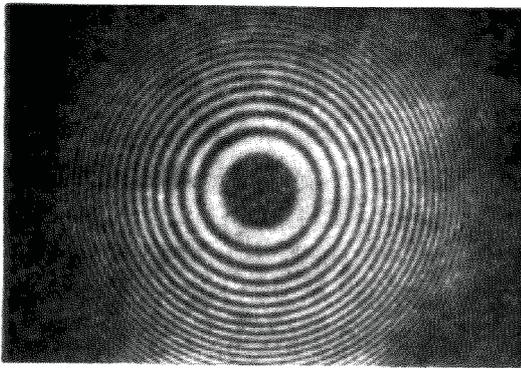
Die Halbkugel liege mit der gekrümmten Fläche auf der Glasplatte und es falle monochromatisches, paralleles Licht der Wellenlänge  $\lambda$  von oben senkrecht in die Anordnung. Die linke Abbildung zeigt das resultierende, kreisförmige Interferenzmuster. Der horizontale Abstand  $a$  vom Kontaktpunkt Kugeloberfläche/Glasplatte, also vom Zentrum des Interferenzbildes, sei sehr viel kleiner als der Radius  $R$  der Halbkugel, so dass Brechungseffekte vernachlässigt werden können.
