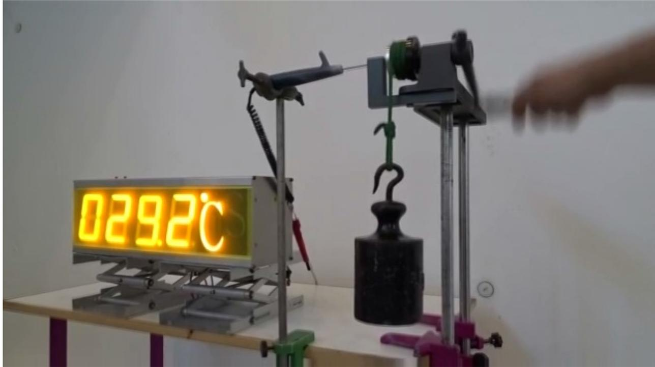
Führt man einem Stoff die Energie  $\Delta W$  zu, so beobachtet man eine Temperaturänderung  $\Delta T$ , die proportional zu seiner Masse  $M$  ist. Man nennt die mit Temperaturänderung verbundene Energie die **Wärmemenge**  $Q$ , führt ihm also über  $\Delta W$  die Wärme
