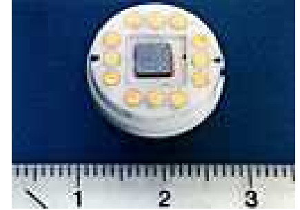
Quanten-Hall-Widerstands-Normal zur Bewahrung und Weitergabe der Widerstandseinheit.
