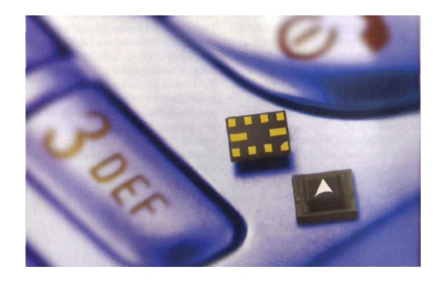
Frequenzfilter für Handys, welche auf so genannten akustischen Oberflächenwellenelementen (SAW) beruhen, werden immer winziger. Hier ist ein typischer SAW-Frequenzfilter (Kantenlänge 2 mm) für ein modernes Dualband-Handy zu sehen. (Quelle: Epcos)
