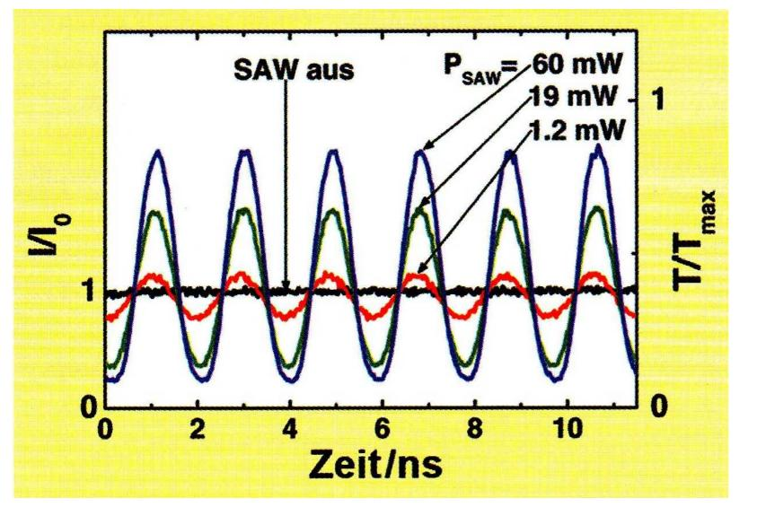
Beck et al., PhiuZ 2 (2007) Zeitaufgelöste Transmission durch das Mach-Zehnder-Interferometer bei drei Leistungswerten der akustischen Oberflächenwelle. Linke Ordinate: gemessene Intensität bezogen auf Intensität ohne Oberflächenwelle, rechte Ordinate: berechneter Transmissionskoeffzient.
