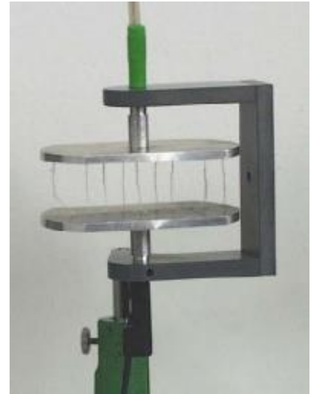
Demonstration: elektrische Feldlinien im Plattenkondensator
