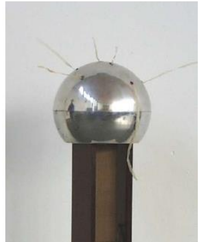
Demonstration: elektrische Feldlinien mit van de Graaf Generator
