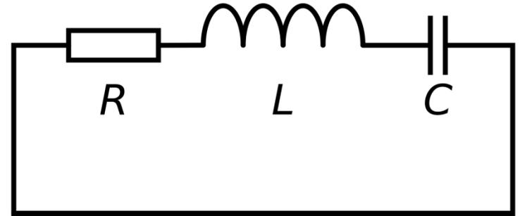
Für schwache Dämpfung  $\gamma < \omega_0$  ( $R^2 < 4L/C$ ) ergibt sich somit:
