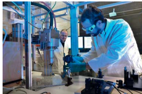
Der Plasmajet PFW10 der Firma Plasmatreteat wird für Reinigungs-, Aktivierungs- und Beschichtungsprozesse eingesetzt (Foto: CAU Kiel)
