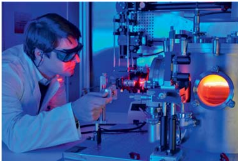
Anlage zur Partikelmanipulation in der Plasmarandschicht mit einer Laserpinzette (Foto CAU)
