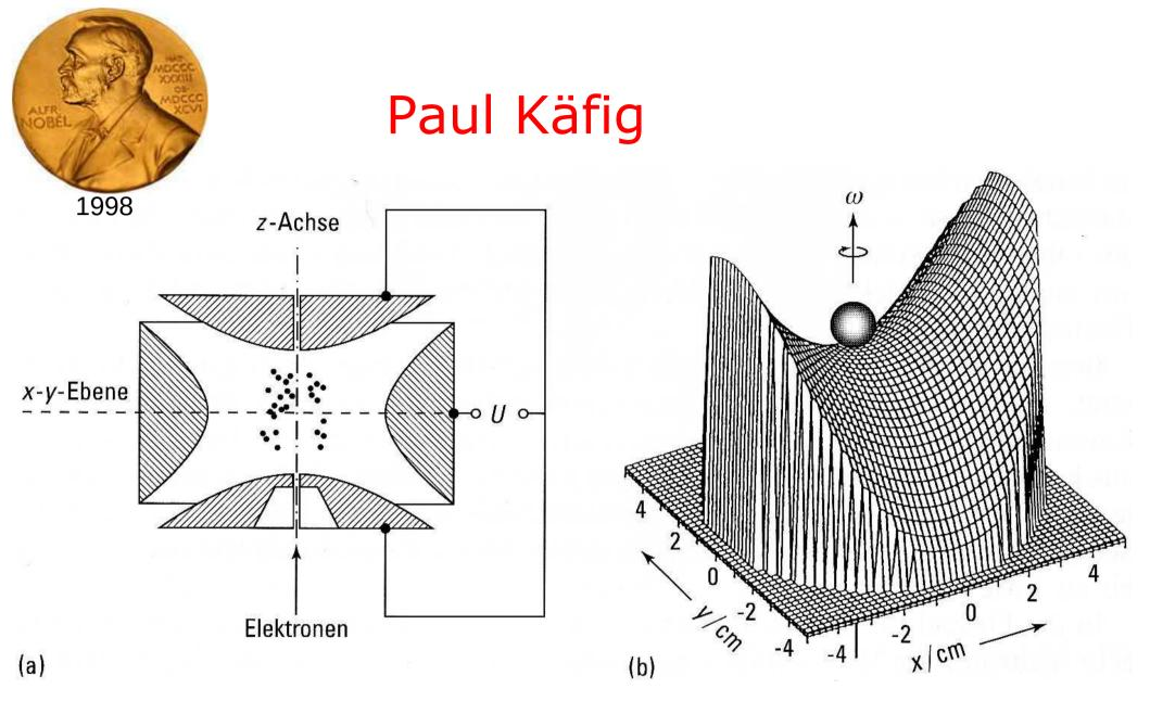
Abb. 11.35 (a) Querschnitt des Paul-Käfigs; am Käfig liegt Gleich- und Wechselspannung. (b) Mechanisches Analogmodell für den Käfig mit einer Stahlkugel als "Teilchen" (W. Paul, Nobelvortrag 1989).
