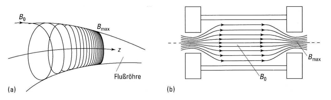
Abb. 11.33 (a) Magnetischer Spiegel: ein geladenes Teilchen wird in einem zunehmenden magnetischen Feld reflektiert. (b) Magnetische Flasche mit magnetischen Spiegeln an beiden Enden (schematisch).
