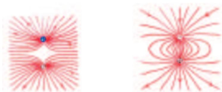
Abbildung 4.3: Visualisierung der elektrostatischen Wechselwirkung zwischen Punktladungen.
