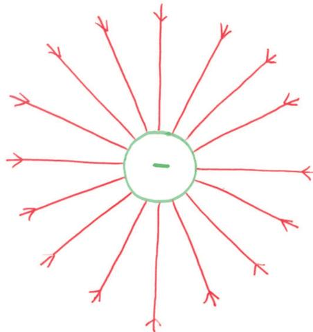
Abbildung 4.2: Das elektrische Feld einer negativ geladenen Kugel.
