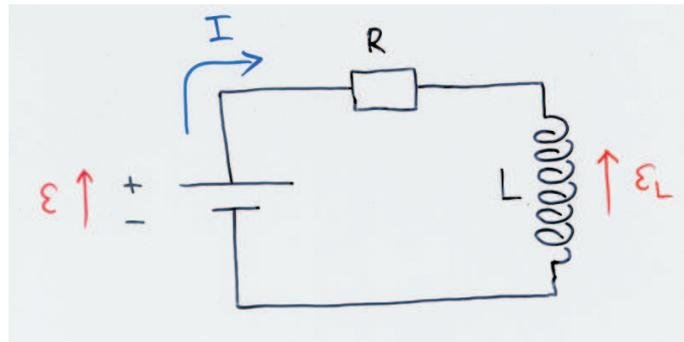
Abbildung 4.24: Speicherung von Energie im magnetischen Feld.
