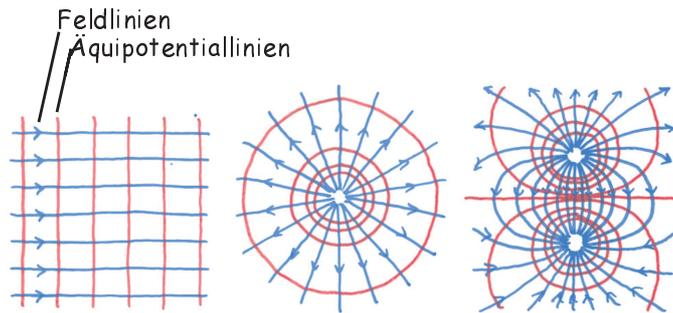
Abbildung 4.5: Äquipotentiallinien verschiedener elektrischer Felder.
