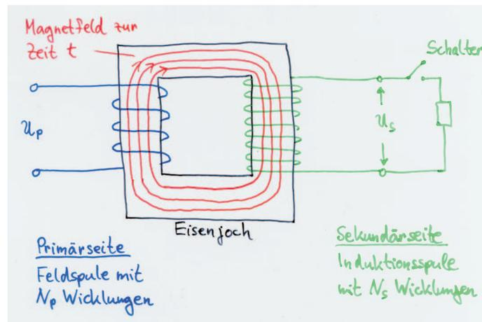
Abbildung 4.26: Transformator.
