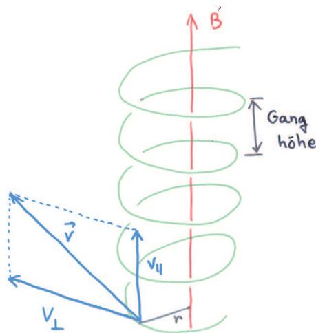
Abbildung 4.19: Spiralförmige Trajektorie eines geladenen Teilchens, dessen Geschwindigkeit  $\vec{v}$  nicht senkrecht zum Magnetfeld  $\vec{B}$  gerichtet ist.
