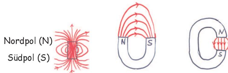
Abbildung 4.17: Beispiele für magnetische Feldlinien: Die Richtung verläuft vom Nord- zum Südpol, die Linien bilden geschlossene Schleifen.
