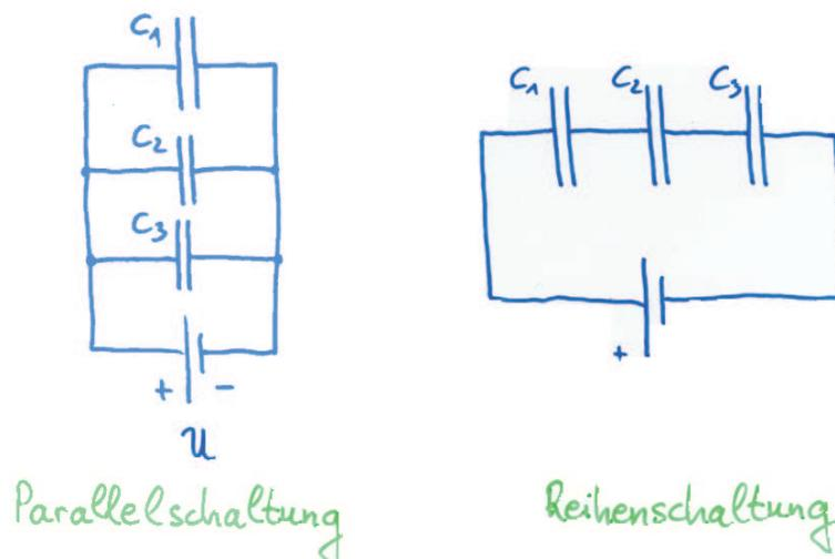
Abbildung 4.8: Parallel- und Reihenschaltung von Kondensatoren.
