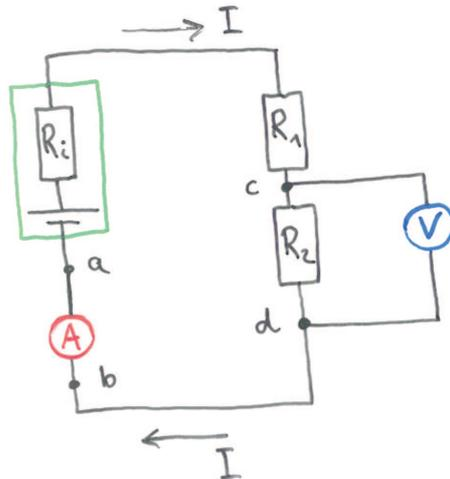
Abbildung 4.16: Strom- und Spannungsmesser im Stromkreis.
