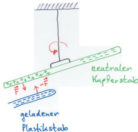
Abbildung 4.1: Ladungstrennung in einem neutralen Kupferstab.
