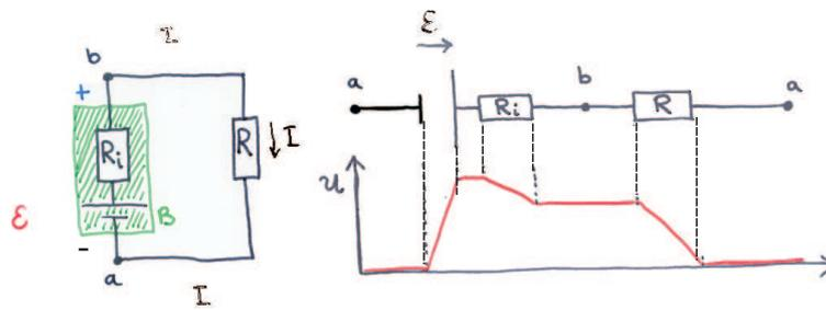
Abbildung 4.14: Eine reale EMK-Quelle besitzt einen inneren Widerstand.
