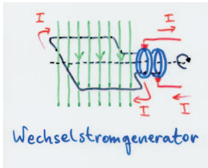
Abbildung 4.25: Elektrischer Generator.
