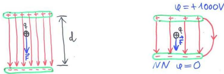
Abbildung 4.4: Ladung im homogenen elektrischen Feld.
