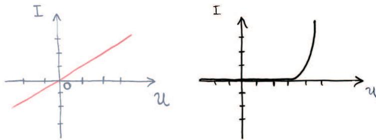
Abbildung 4.11: Strom-Spannung-Charakteristik für einen Ohmschen Widerstand (links) und eine Halbleiterdiode (rechts).
