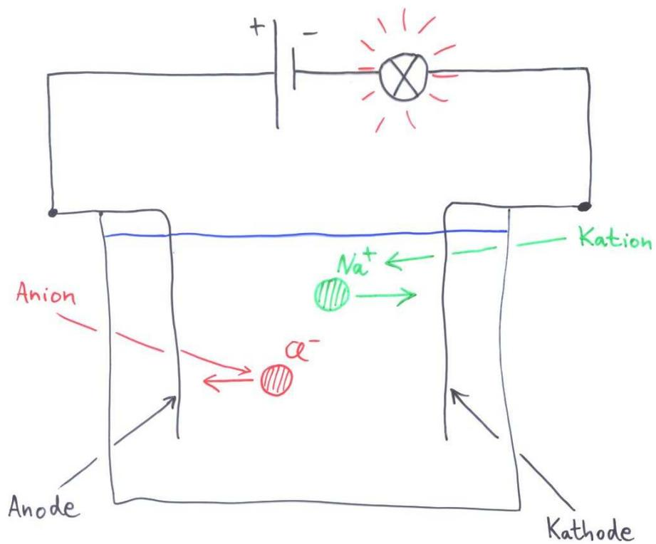
Abbildung 4.12: Prinzip der Elektrolyse: In wässriger Lösung dissoziiert der Kochsalz-Kristall in die Ionen  $\text{Na}^+$  und  $\text{Cl}^-$ , die von der Kathode bzw. der Anode angezogen werden. Dieser Ladungstransport lässt die Glühlampe im Stromkreis leuchten.
