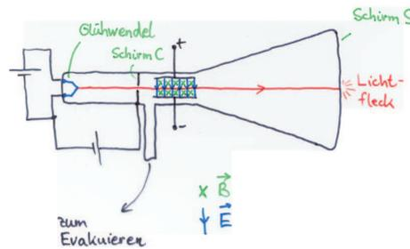
Abbildung 4.18: Thomsons prinzipieller Versuchsaufbau, der zur Entdeckung des Elektrons geführt hat.
