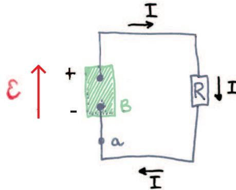
Abbildung 4.13: Die elektromotorische Kraft  $\mathcal{E}$  verrichtet Arbeit an den Ladungen und sorgt für einen konstanten Strom im Stromkreis.
