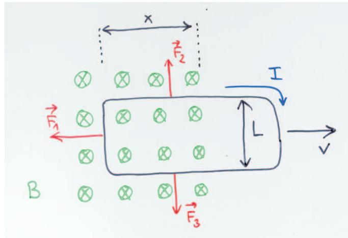
Abbildung 4.23: Berechnung der Leistung beim Ziehen einer Leiterschleife im homogenen Magnetfeld.
