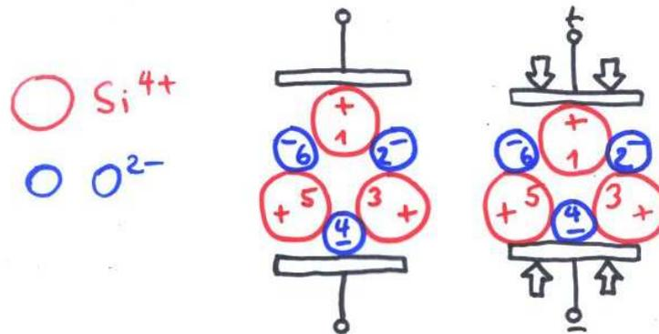
Abbildung 4.10: Schwingquarz und Piezo-Effekt.
