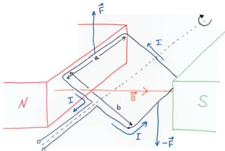
Abbildung 4.20: Leiterschleife im homogenen magnetischen Feld.
